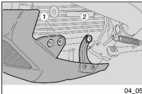
Para el cambio de aceite del motor y del filtro de aceite, se debe retirar el cubrecárter.
